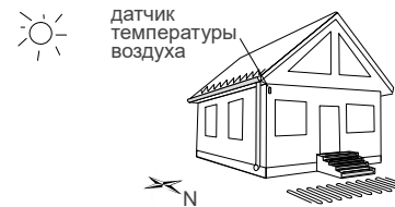
Рисунок 1. Монтаж датчика температуры воздуха
